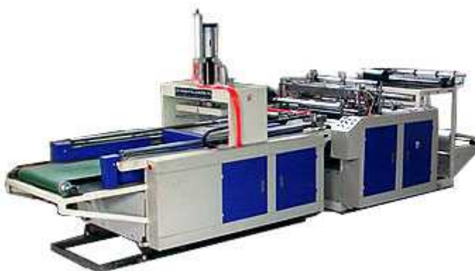
Пакетосварочный станок серии DFR с пневмосистемой автовысечки ручек
